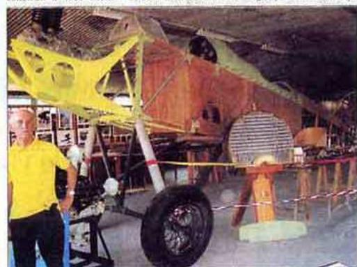
L'empennage du Potez 25 avec, au premier plan, le radiateur construit à l'identique
