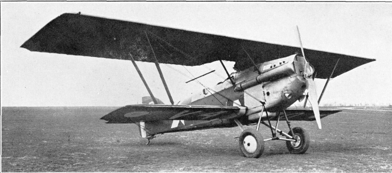
L'avion Potez 25 T. O. E. équipé du moteur Lorraine 450 CV.
