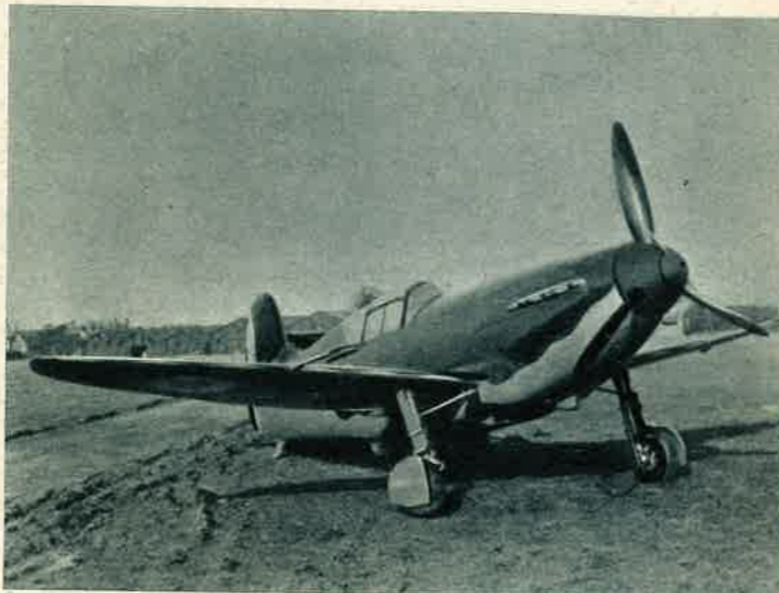
Le monoplace de chasse Potez 230 volait à 560 km-h. avec 670 ch. seulement.
