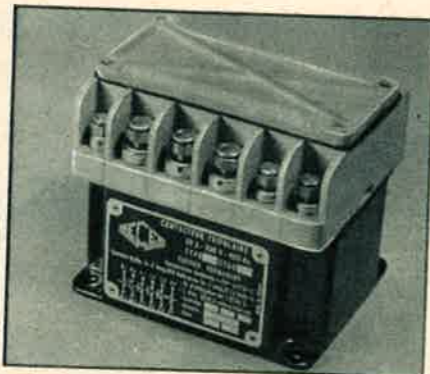
BOITIERS DE COMMANDE et de protection pour des alternateurs de puissances comprises entre 4 et 60 Kva. Ils assurent le couplage automatique aux barres omnibus alternatives et la protection des alternateurs de bord triphasés à fréquence fixe (400 Hz) ou variable (380-1000 Hz) de tensions nominales 120/208 volts. Ils sont sensibles à la tension, la fréquence, les surtensions, les surfréquences, les surcharges et les défauts de feeders.
