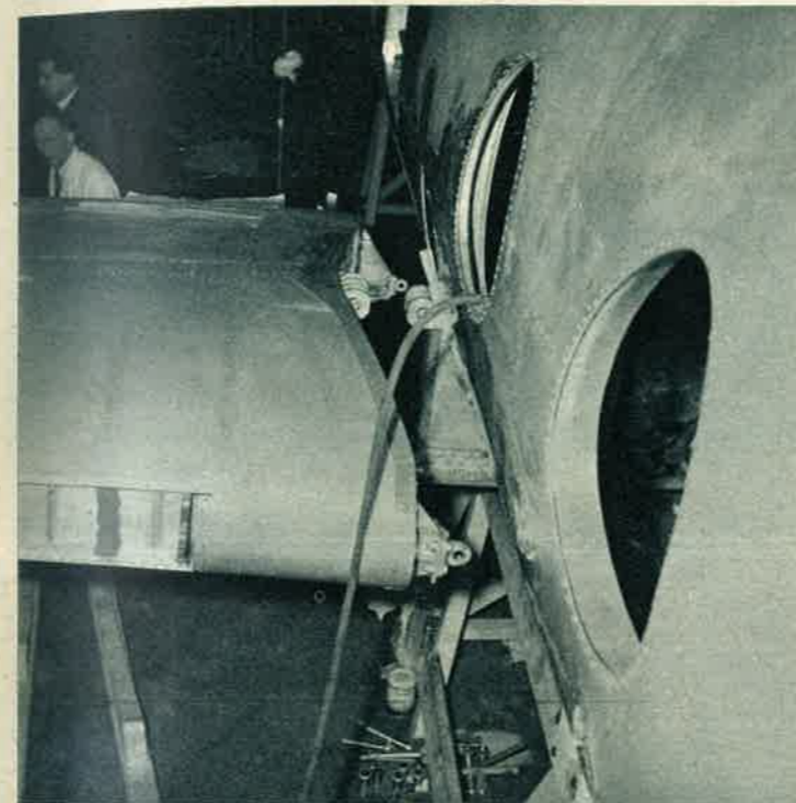
Détail de l'attache de l'aile montrant les doubles ferrures principales.
