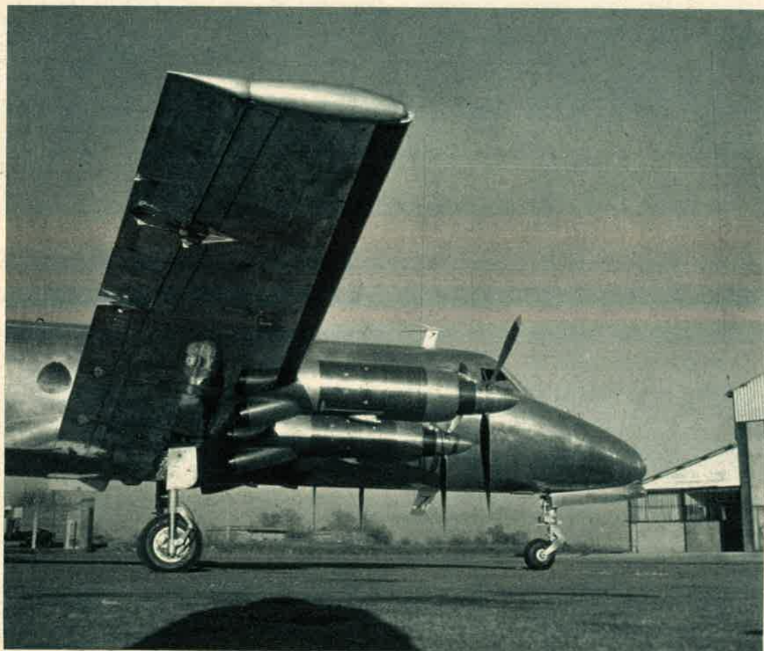
Une aile fine de grand allongement d'où surgissent les deux « crayons » des turbopropulseurs droits, un avant plongeant accordant une excellente visibilité vers l'avant, quelques particularités du P.840...
