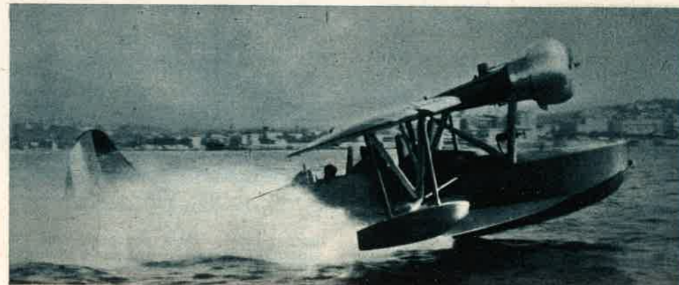
Un décollage d'un Potez 452 de série à moteur Hispano de 350 ch. L'appareil va passer sur le redan!
