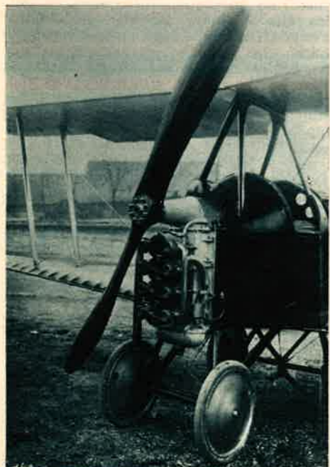
Le premier moteur Potez et la curieuse disposition de ses quatre cylindres superposés.
