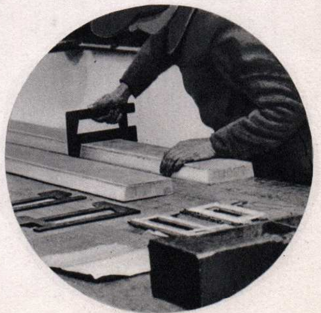
Des gabarits tant pour la précision de fabrication que pour le contrôle.
