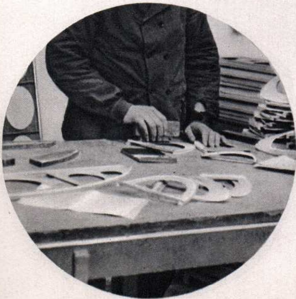
Des gabarits tant pour la précision de fabrication que pour le contrôle.
